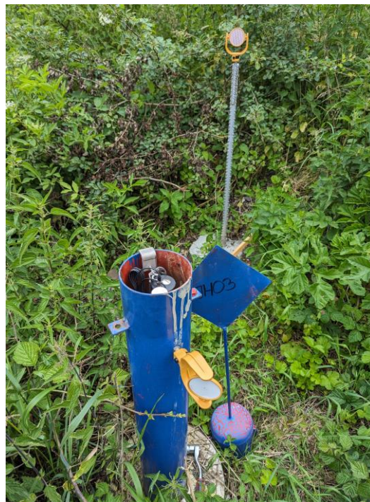
Vlevo - Uložení systému automatického inklinometrického měření ve zhlaví vrtu IJ 102
