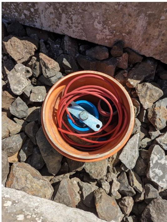
Vlevo - Uložení systému automatického inklinometrického měření ve zhlaví vrtu IJ 102
