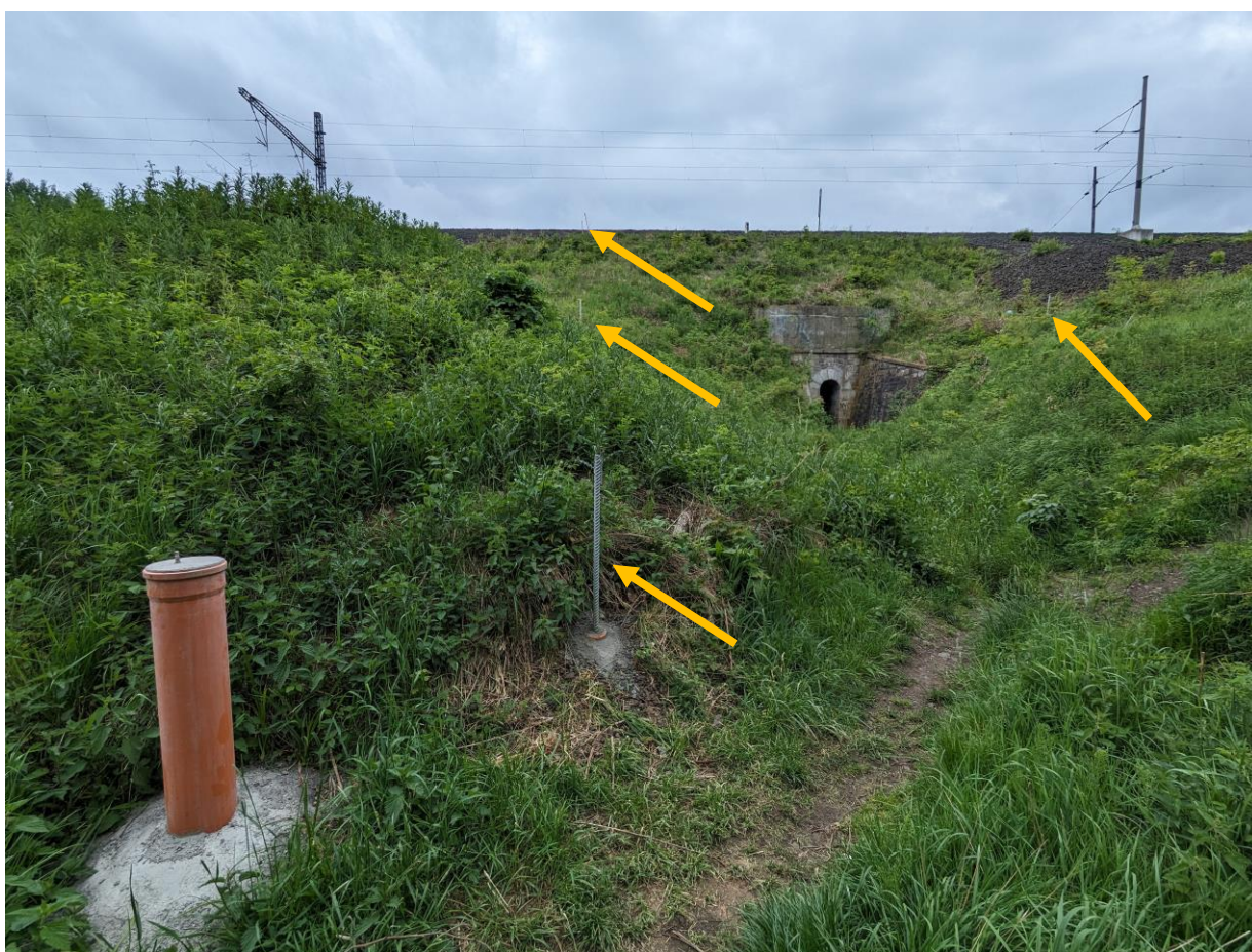
Pohled na geodetický pilíř GP3 a geodetické body v profilu PR II, který obsahuje i jeden bod za křídlem propustku.
